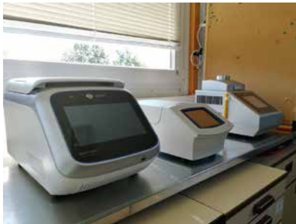
PCR készülékek. Funkciójukat tekintve valójában a hőmérsékletet gyorsan változtatni tudó termosztátok, amelyek a megadott protokoll alapján végzik a DNS szintetizálását.
