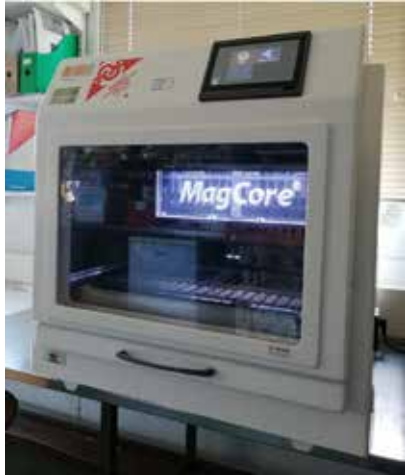
MagCore izoláló robot, mely egyidőben 16 minta izolálását teszi lehetővé.
